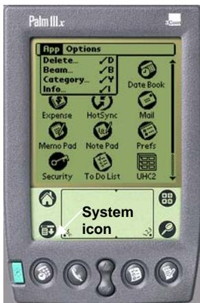
**Passo 1:** A partir de um dos ecrã principais, toque no mostrador de tempo, no canto superior à direita do ecrã, ou no ícone System, no fundo à esquerda. É indicada uma lista de opções.
