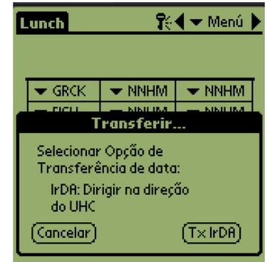
**Passo 6:** A lente de recepção na frente do gabinete UHC-P deve estar limpa. Segure o Palm Pilot paralelo com o piso e aponte-o para a lente no máximo a 30 cm de distância.
