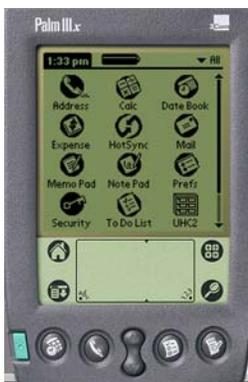
**Passo 1:** Posicione as cabeças dos Palms conforme indicado. Elimine qualquer versão anterior do software para o UHC-P do Palm a receber. Na unidade que contém o software UHC-P, toque no mostrador de tempo (em cima à esquerda) ou no ícone System (em baixo à esquerda).
