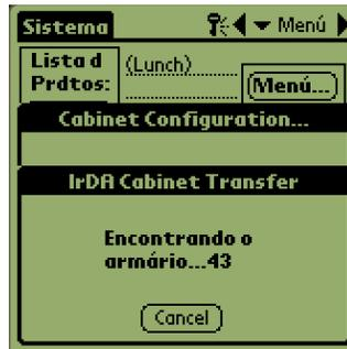
**Passo 7:** Com o Palm na horizontal e a uma distância de cerca de 35 cm da lente de recepção do armário, toque no botão Transmitir. É indicado o menu Transfer. Será indicada uma mensagem ao iniciar a transferência e logo que a transferência tiver terminado.
