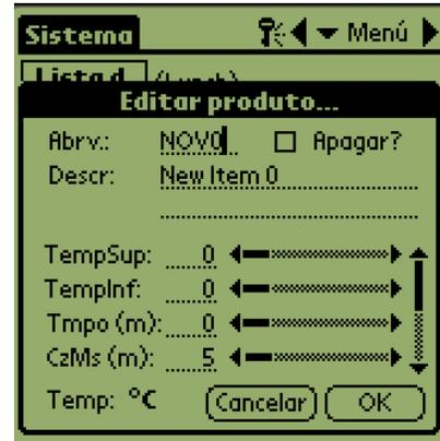
**Passo 6:** De seguida, toque nos valores de temperatura sublinhados, e toque no ícone de números no fundo à direita do ecrã do Palm. É indicado um teclado numérico. Utilize o teclado – tanto como a teclado indicado no passo 4 – para introduzir os valores pré-definidos das temperaturas, definir o tempo de guarda, os tempos de Cozer mais e as lâmpadas de contagem decrescente. As barras deslizantes horizontais podem ser utilizadas também para ajustar as temperaturas e tempos.
