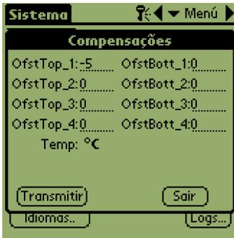
**Passo 6:** A compensação introduzida é indicada no menu. Neste caso, introduzimos um valor de compensação para a placa superior do slot superior de  $-5^{\circ}\text{C}$ . Ajuste os outros slots conforme necessário.
